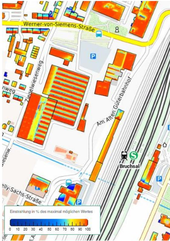
Die mittlere jährliche Solareinstrahlung für horizontale Flächen in [kWh/m<sup>2</sup>] beträgt gemäß LUBW-Kartendienst 1.099 kWh/m<sup>2</sup>. Das Solarpotenzial auf den Dachflächen ist je nach Neigung, Ausrichtung oder Verschattung als gut bis sehr gut eingestuft.
