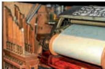
Spielvorrichtung mit Lochband (Programmträger). Orchestrion „Unika“, Fa. Gebr. Weber, Waldkirch, 1924 Foto: Klaus Biber, Deutsches Musikautomaten-Museum
