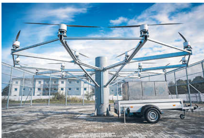
Das Gestell mit den volocoptertypischen 18 Rotoren Foto: Volocopter
