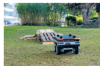
Das Transportfahrzeug orientiert sich zuverlässig im Außenbereich Foto: Philipp Reichenbach
